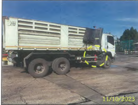
การจัดให้มีถังดับเพลิงชนิดผงเคมีแห้งชนิด 6A/20B สำหรับรถบรรทุก จำนวน 2 ถัง
